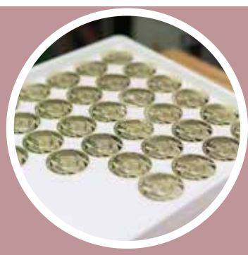
Verktøymaker Tor Olav polerer stemplene etter fresing og gjør de klare til bruk.
