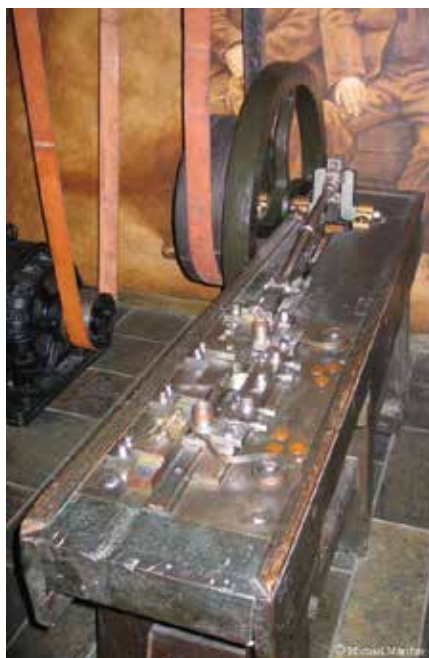
Dobbelt randingsmaskin fra 1800-tallet av samme type som knuste et par av Ferdinand Engmanns fingre ved myntverket i København i 1811. Maskinen er utstilt i Kongsberg som en del av samlingen hos Norges Bergverksmuseum. Foto: Frode Sæland/BVM.
